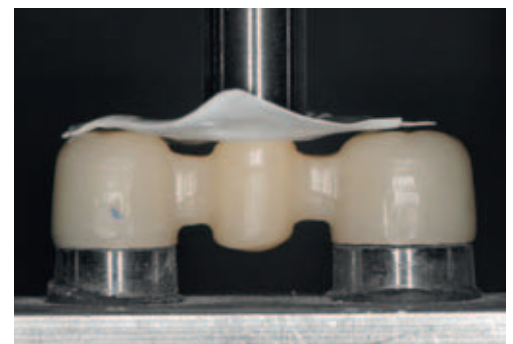
Abb. 12 Die Brücke in der Prüfapparatur.
