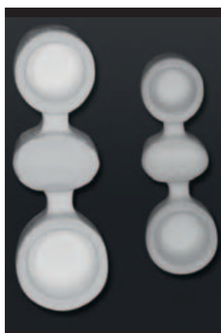
Abb. 7 Zirkoniumdioxidbrücken, links im Weißzustand, rechts dichtgesintert.
